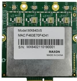
MX-640V5 是一款配有 PCI Express 3.0 界面及 M.2 E-key 的内嵌型无线网卡。该无线网卡采用 Qualcomm® 802.11ax Wi-Fi 6 技术，支持 5180-5850GHz 频段，可执行 AP 及 STA 功能，同时具备 4x4 MIMO 和 4 个空间流，适用于 5GHz IEEE802.11a/n/ac/ax 应用，相比上一代无线网卡的传输效率更高，并具备动态频率选择(DFS)功能。
